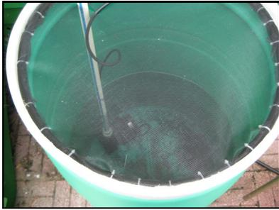
A POND PUMP CAN BE USED TO INCREASE WATER PRESSURE AND RUN A MICRO-IRRIGATION SYSTEM.
